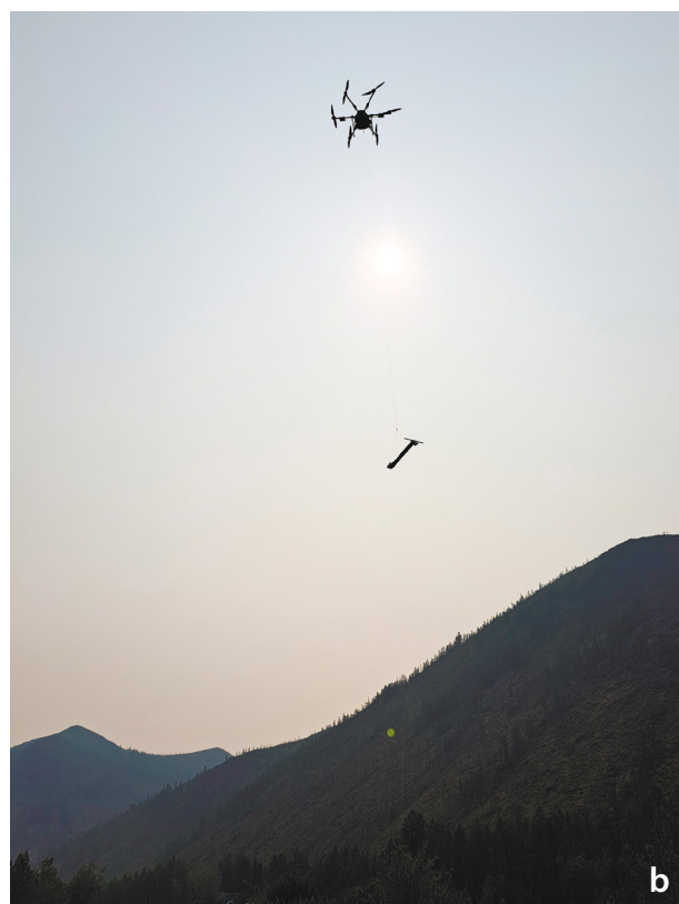
Рис. 1. Внешний вид регистратора «МЭМИ» (a) и полет по рабочему маршруту с регистратором на подвесе (b)
